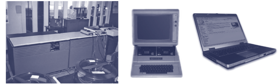
Figuur 1.2: Foto's van verschillende types van computers: (links) de Honeywell-Bull DPS 7-mainframe computer uit 1981, (midden) de Apple II personal computer, en (rechts) een typische laptop uit 2004, die op de schoot kan worden gebruikt.
