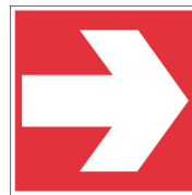
Drumul către stingerea incendiilor
