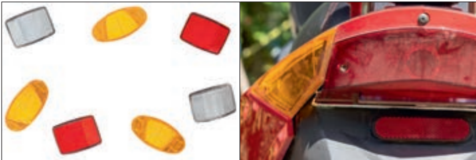
Retroreflectoren zijn er in verschillende kleuren en zorgen ervoor dat voertuigen ook tijdens parkeren zichtbaar zijn in het donker.
