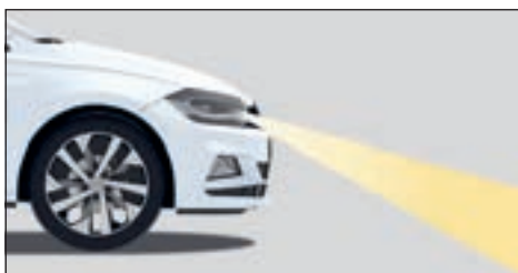
Dimlicht verlicht de weg voor het voertuig, zonder tegemoetkomend verkeer te verblinden.
