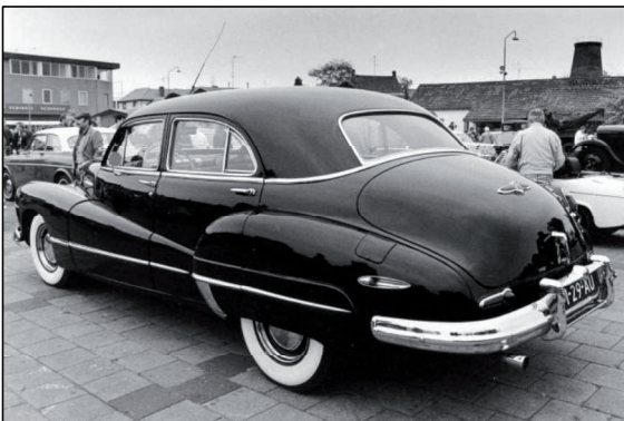
1949 Buick 40-serie Special Sedanet met een 4066 cc achtcilinder in lijn met kopklepbediening en 110 pk vermogen bij 3600 omw/min. Eigen leeg gewicht 1820 kg. Lengte 5,28 meter. Onder: 1948 Buick 50-serie Super vierdeurs sedan met een 115 pk achtcilinder in lijn. (foto's auteur).
