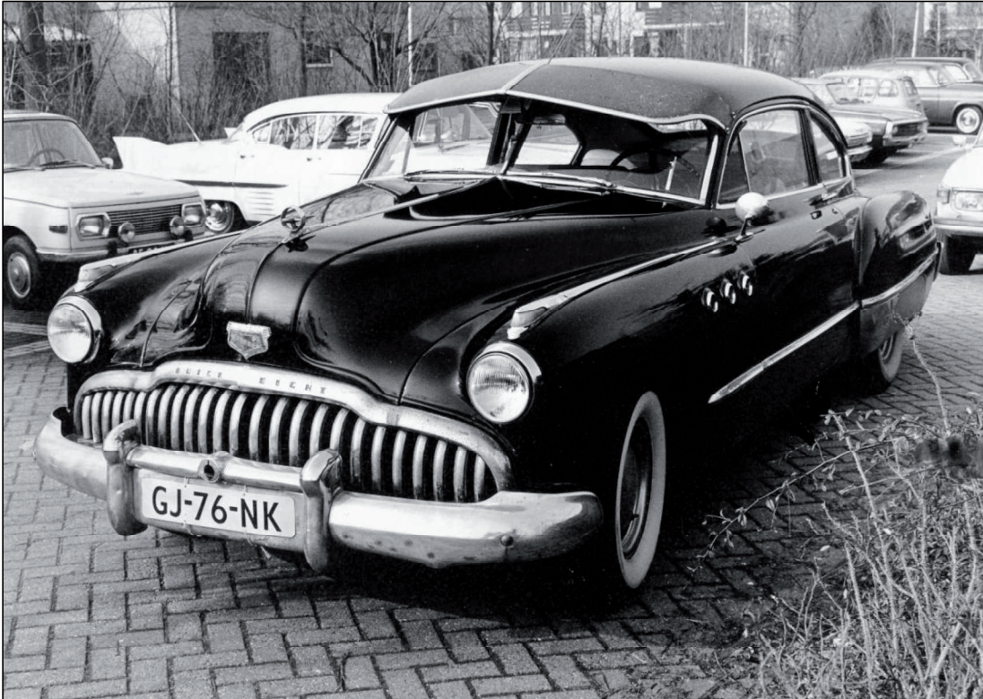
1949 Buick 40-serie Special Sedanet met een 4066 cc achtcilinder in lijn met kopklepbediening en 110 pk vermogen bij 3600 omw/min. Eigen leeg gewicht 1820 kg. Lengte 5,28 meter. Onder: 1948 Buick 50-serie Super vierdeurs sedan met een 115 pk achtcilinder in lijn. (foto's auteur).
