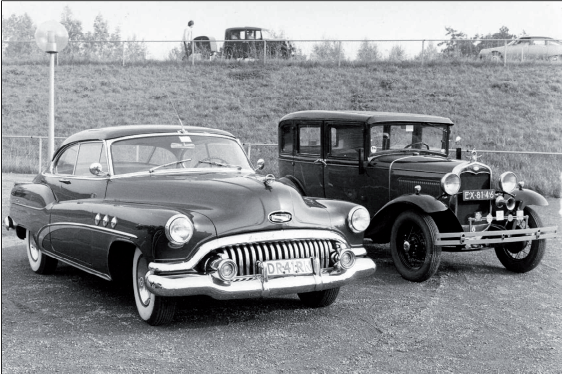
1952 Buick model 52 Super Riviera sedan met een 124/128 pk achtcilinder in lijn. Het meest populaire model van de GM-divisie dit jaar verscheen in een oplage van 71.387 stuks. Rechts een 1931 A-Ford Fordor Standard met een 3285 cc viercilinder zijklepmotor van 40 pk. (foto auteur).
