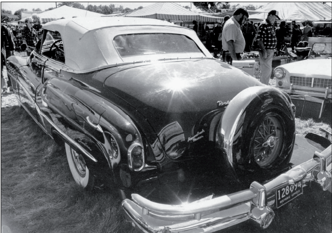
1953 vierpersoons Buick 70-serie Roadmaster Skylark met een 188 pk V8-motor. Onder: 1951 Buick Roadmaster model 76-C met een 152 pk achtcilinder in lijn en een nieuwprijs van 3283 dollar. Van dit vierzits model werden 2911 stuks gebouwd en met cabriolets was Buick de derde grootste fabrikant in de Verenigde Staten. Het reservewiel in een verchromde trommel was een optie. (foto's auteur).
