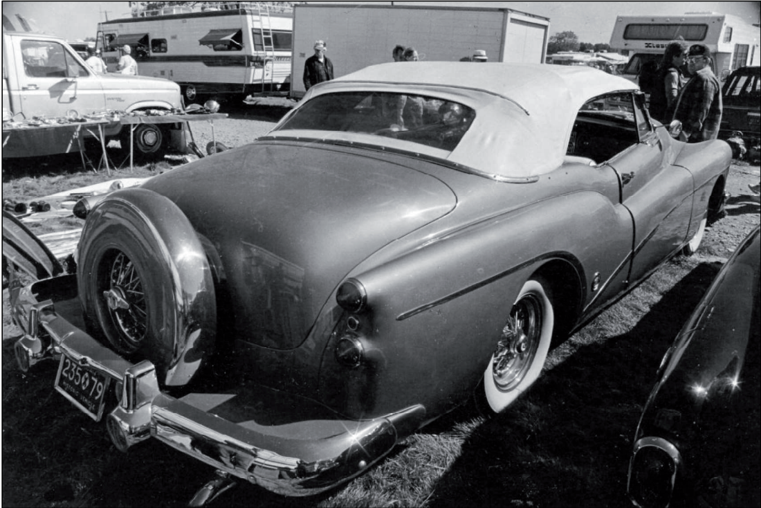
1953 vierpersoons Buick 70-serie Roadmaster Skylark met een 188 pk V8-motor. Onder: 1951 Buick Roadmaster model 76-C met een 152 pk achtcilinder in lijn en een nieuwprijs van 3283 dollar. Van dit vierzits model werden 2911 stuks gebouwd en met cabriolets was Buick de derde grootste fabrikant in de Verenigde Staten. Het reservewiel in een verchromde trommel was een optie. (foto's auteur).
