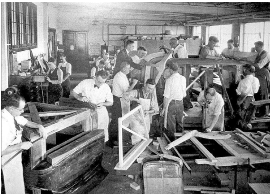
Samenstelling van houten carrosserieframes bij de Fisher Body Corporation, dat in 1926 een divisie van General Motors Corporation werd. (Coll. Auteur).
