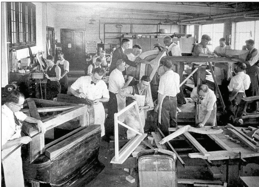
Samenstelling van houten carrosserieframes bij de Fisher Body Corporation, dat in 1926 een divisie van General Motors Corporation werd. (Coll. Auteur).
