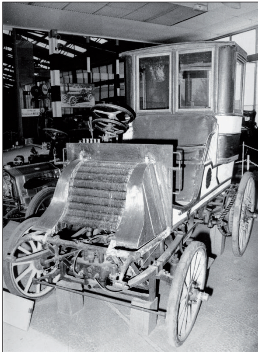
1901 Audibert et Lavirotte Coupé Chauffeur met een tweecilinder boxermotor en kettingaandrijving. (foto auteur).
