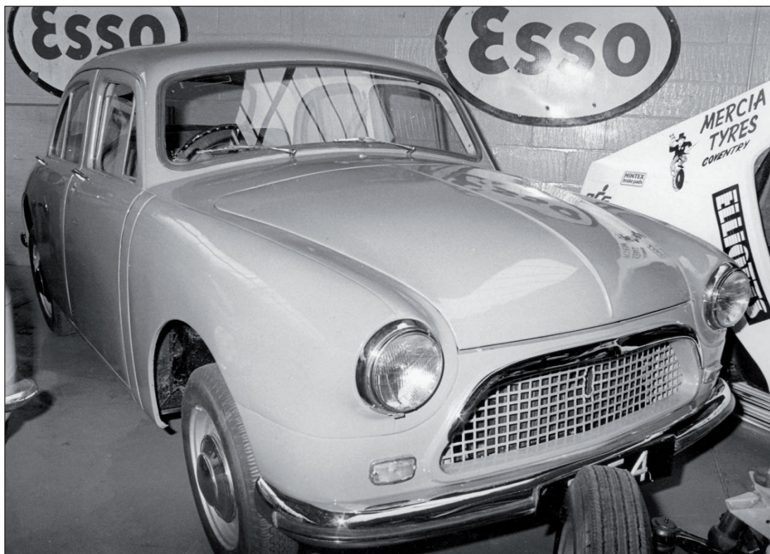
1954 Ferguson R4 prototype. Vierwielaandrijving, schijfremmen op de voorwielen met Dunlop-Maxaret antiblokkeersysteem en een watergekoelde viercilinder boxermotor met bovenliggende nokkenas. (foto auteur). Onder: het constructieprincipe van de Ferguson R4. (Coll. Auteur).
