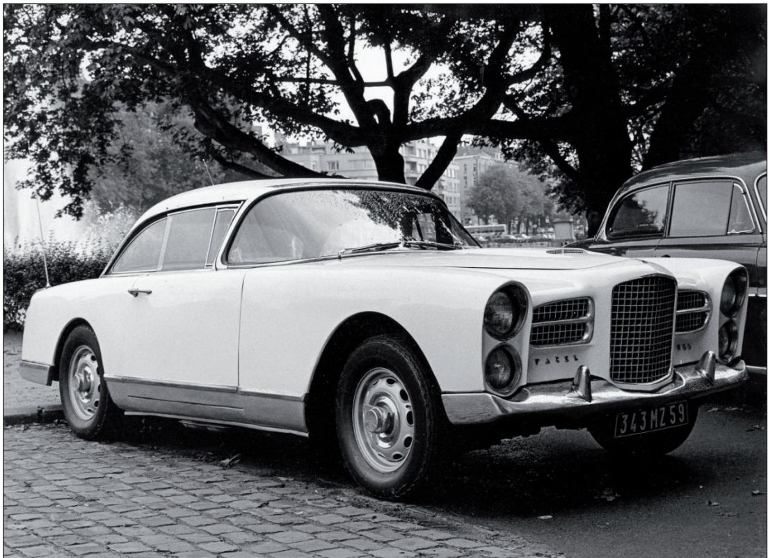
1959 Facel-Vega HK 500 hardtop coupé. Wielbasis 2,66 meter, lengte 4,59 meter. Een DeSoto Firedome 5907 cc V8-motor met halfbolvormige verbrandingskamers leverde een vermogen van 360 pk bij 5200 omw/min. Topsnelheid 230 km/u bij een verbruik van ca. 24 liter per 100 kilometer. Productieaantal 490 stuks in drie jaar tijd. (foto auteur).
