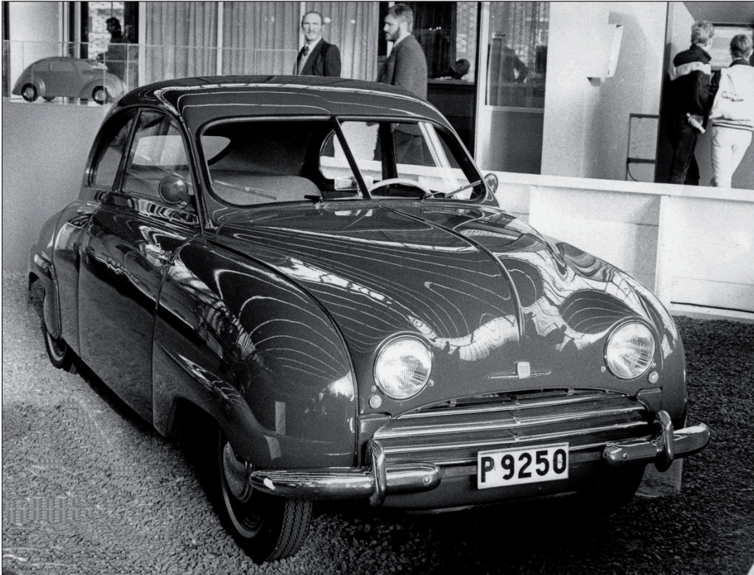
1950 Saab 92 coach met een watergekoelde 764 cc tweetakt tweecilindermotor van 25 pk bij 3800 omw/min. Zelfdragende carrosserie, voorwielaandrijving. Topsnelheid 100 km/u. (foto auteur).
