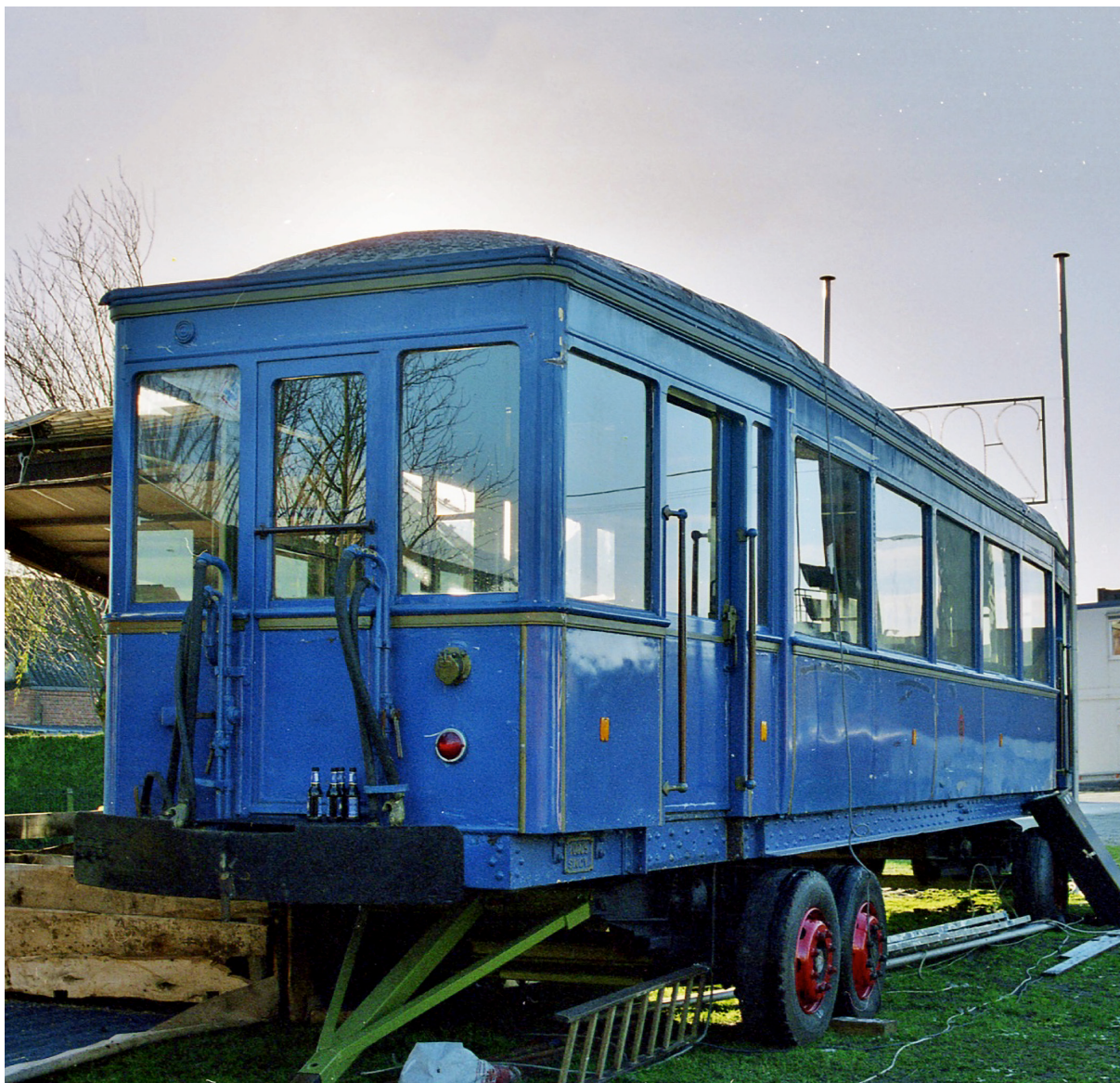
De tram aan Humbeek kanaal, tijdens de kerstmarkt, op 23 december 2003. Hier ziet men duidelijk dat de tram zijn tramwielen heeft ingewisseld voor een chassis op rubberen banden, afkomstig van een landbouwvoertuig. Foto Stefan Justens
