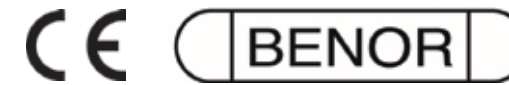
Figuur 1.6: De CE-markering en het BENOR-merk zijn aanduidingen van kwaliteitsgarantie bij cement.
