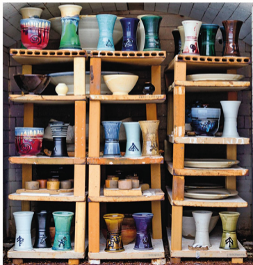
Gasovens, zoals de Geil-oven op de foto, worden gebruikt voor reductiebranden (zie blz. 141-144).
