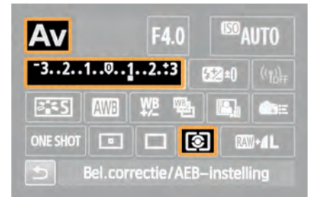
Diafragma voorkeur, Belichtingscompensatie (+1 Ev) en Matrixmeting (v.l.n.r.).
