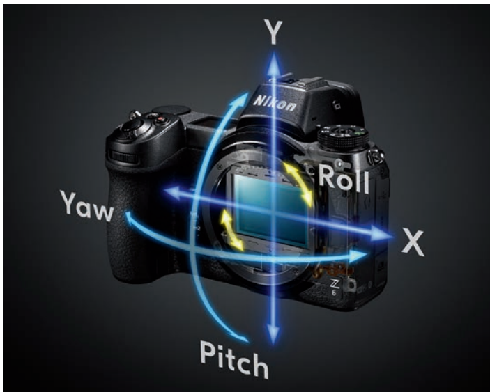
De vijf assen resp. richtingen waarin de beeldstabilisator van de Z6 en Z7 werkt (afbeelding: Nikon).
