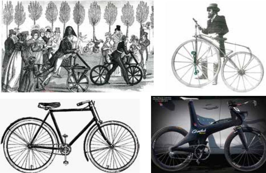
Figuur 1-4. Enkele mijlpalen in het ontwerp van de fiets. Linksboven: de ‘houten’ Draisienne, een loopfiets; rechtsboven: de voorwielangedreven (houten/stalen) fiets van Pierre Lallemand; linksonder: de ‘staal/rubber’ Humber met diamantframe en ketting; rechtsonder: de ‘carbon’ fiets, waarbij materialen en aërodynamica elkaar vinden.
