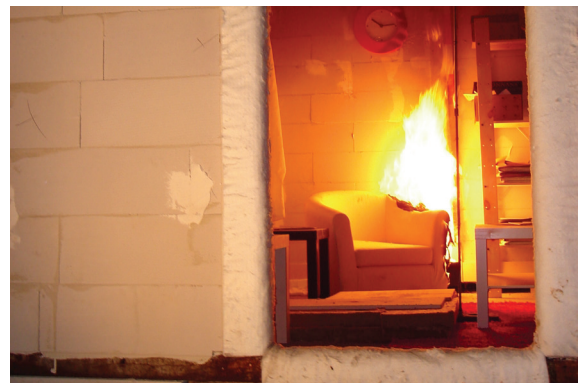
Fig. 2-2 Experimentele bepaling temperatuur woonkamerbrand
