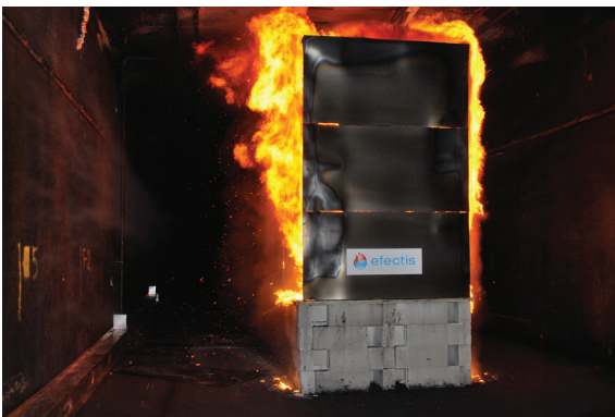
Fig. 2-1 Experiment met een vrachtwagenbrand in een tunnel
