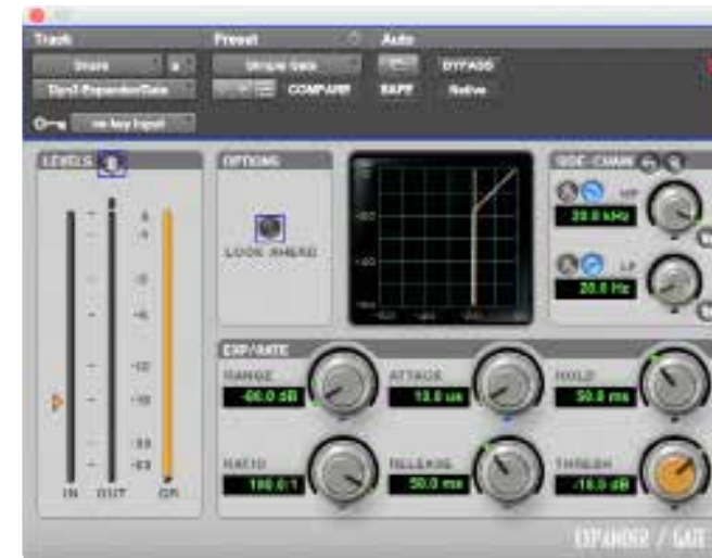
26.8 Dyn3 Expander/Gate in Pro Tools. Met 'Threshold' stel je het volume in waarop de gate opengaat, 'attack' en 'release' bepalen hoe geleidelijk het openen en sluiten verloopt. Met 'lookahead' stel je in hoelang de gate al open is, voor de allereerste transiënt begint. Overigens ten koste van wat extra latency.
