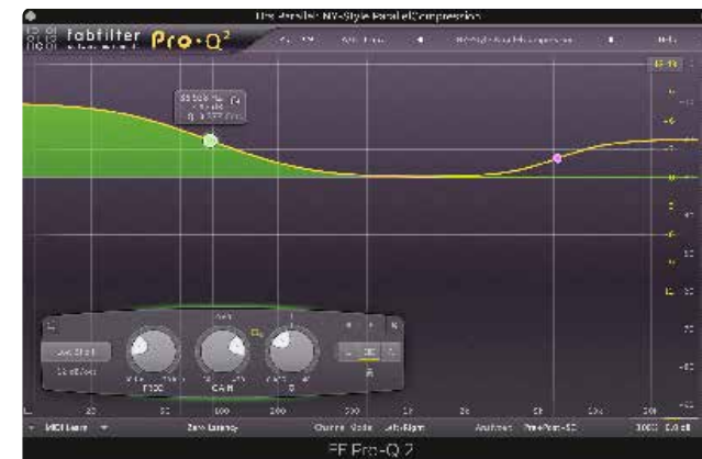
26.6 In een parallel-setup kun je verlies van laag (en eventueel hoog) compenseren door de compressor te laten volgen door een shelf-EQ waarin je laag en hoog boost. Dit noemen we 'New York-style compressie'.
