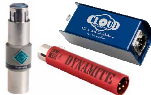
5.11 De Triton Fethead, Cloudlifter CL1 en sE DM1 Dynomite zijn microfoonvoorversterkers die je direct kunt inpluggen op de microfoon, ze worden gevoed door fantoomspanning. Niet alleen zal hierdoor het signaal gezonder zijn zodra het aan het eind van de kabel aankomt, ook beschermen deze versterkers de microfoon tegen het per ongeluk aanzetten van fantoomvoeding. (Foto's tritonaudio.com, cloudmicrophones.com, seelectronics.com)
