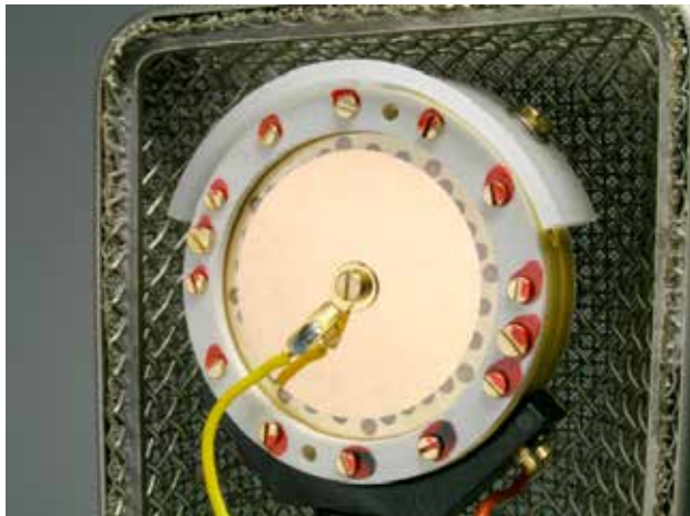
5.5 Kapsel (membraan+ achterplaat) van een condensatormicrofoon.
