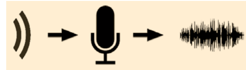
5.1 Van geluidsgolf naar elektrische stroom: de microfoon als transducer.
