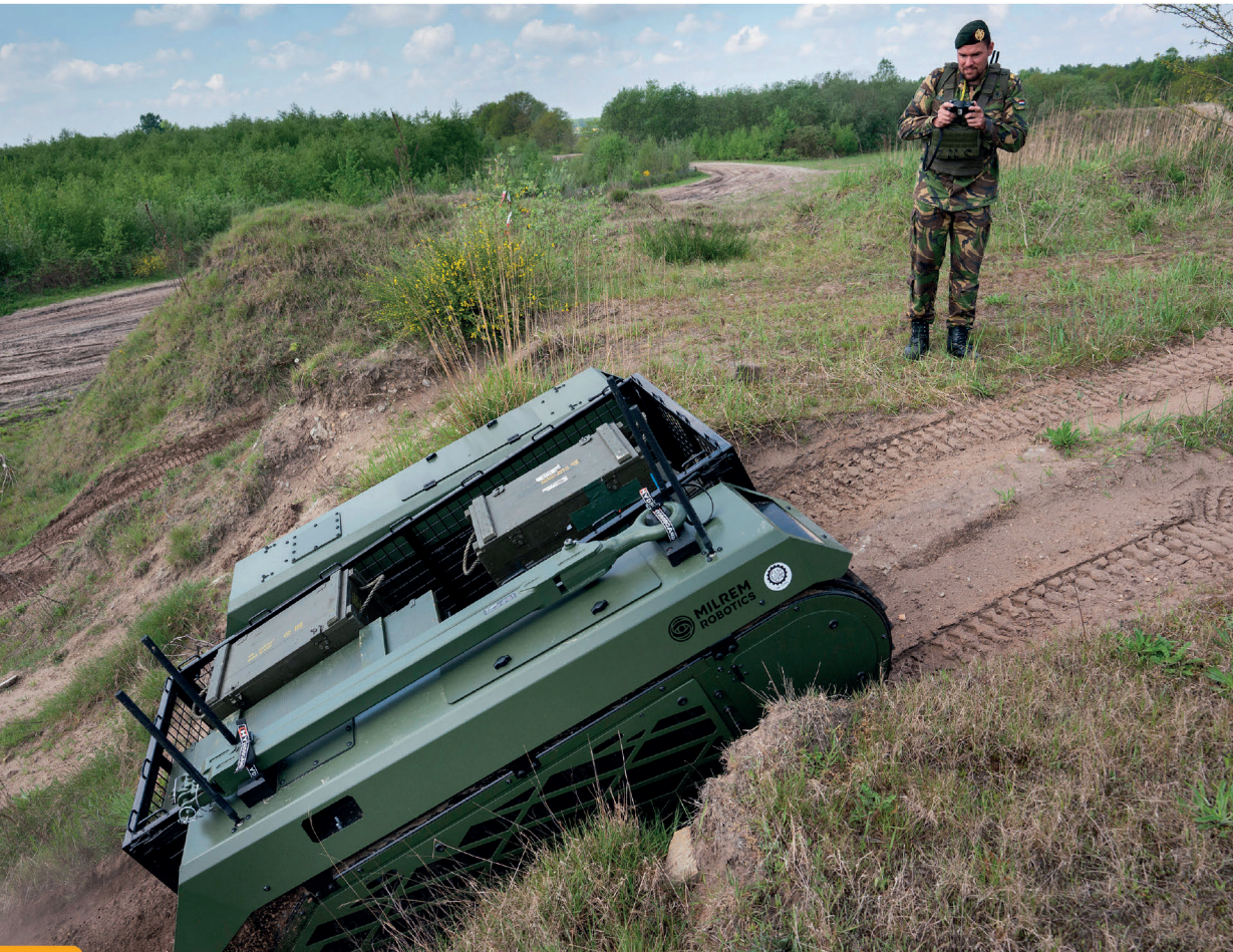
Het onbemande rupsvoertuig THEMIS is gebouwd om grondtroepen te ondersteunen. Het rijdt gemakkelijk over ruw terrein en kan zware wapens, munitie en water meenemen.
