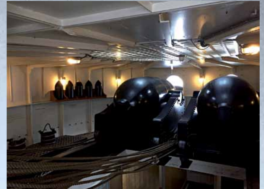
Fig. 6 & 7 Draaibare gepantserde geschutstoren met 2 x 23 cm Armstrong kanons (voorladers).
