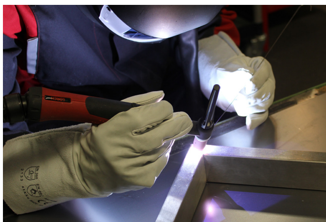
▲ 5. Las vervolgens de stompe zijden af. Ook hiervoor wordt toevoegmateriaal gebruikt.
