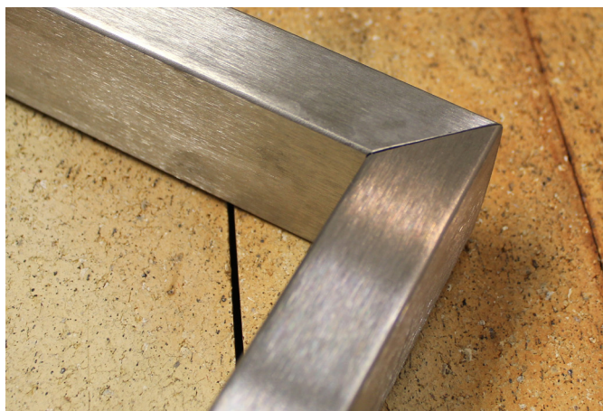
▲ 1. Twee kokers worden onder 90 graden tegen elkaar geplaatst. Zorg ervoor dat de werkstukdelen naadloos aansluiten.
