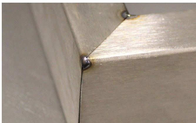
▲ 3. Deze kleine hechtlassen zijn heel belangrijk om vervorming tijdens het lassen te voorkomen.
