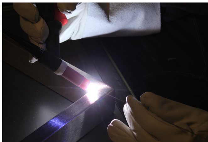
▲ 2. Plaats een aantal hechtlassen om de koker te fixeren. Klem de koker op de werktafel vast om zeker te zijn dat de pasvorm tijdens het hechten optimaal is.
