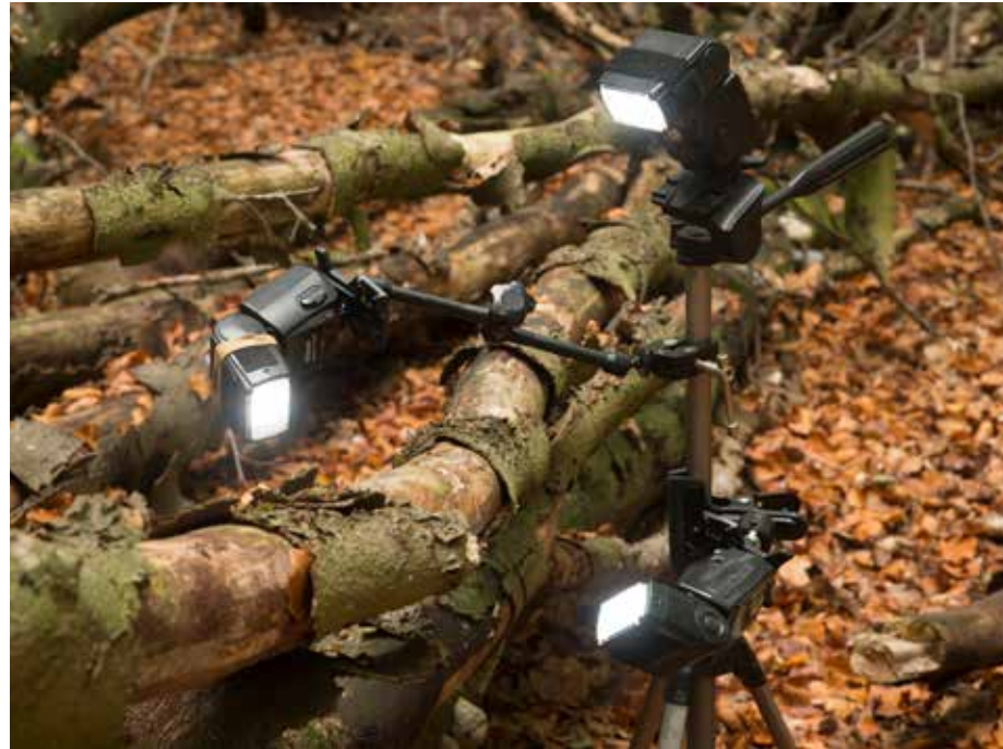
Drie manieren om een flitser te bevestigen. Midden: boven op een eenvoudig statief, links: aan een verstelbare arm, rechts: aan een klem met een balhoofdje. Paul van Hoof.
