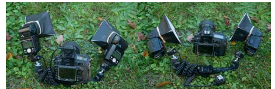
Zelf samengestelde en zeer stevige flitsbeugel voor twee flitsers. De beugel bestaat uit twee metalen armpjes met kleine balhoofdjes om de flitsers te richten. Eén flitser is bekabeld als master, de tweede draadloos als slave. Het geheel is voorzien van een snelkoppeling voor snelle bevestiging aan de camera. Paul van Hoof.
