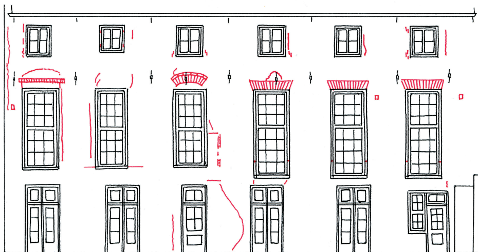
Schets van de noord- en zuidgevel met in rood de bouwsporen. De rode lijnen markeren de naden tussen verschillend metselwerk.
