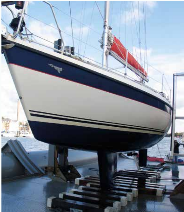
▲ De romp van deze Etap 30 heeft een sandwichconstructie met een schuimkern.
