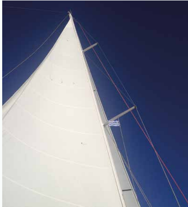
▲ Een van de grootste vijanden van zeilen is uv-licht. Het verzwakt het doek en doet het stiksel verouderen.
