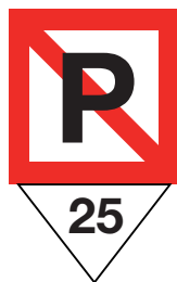
FIG. 1.39A VERBODEN LANGSZIJ TE KOMEN OF AAN TE MEREN BINNEN 25 METER VANAF HET BORD
