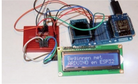
Figuur 49: ESP8266 met Level-converter en I 2 C-display
