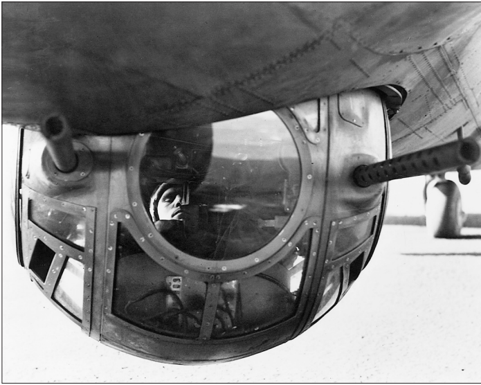
Sergeant Benedict B. Borostowski test de apparatuur van zijn buikkoepel, die zich aan de onderkant van een Flying Fortress bevindt.
