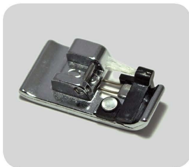
Op de overlockvoet zitten twee kleine metalen staafjes die voorkomen dat de stof oprolt en waardoor het dus mogelijk is een mooi plat, overhands stiksel te maken.
