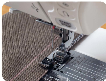
Lijn het metalen staafje uit met de stofrand om de overhandse naad precies op de rand te krijgen.
