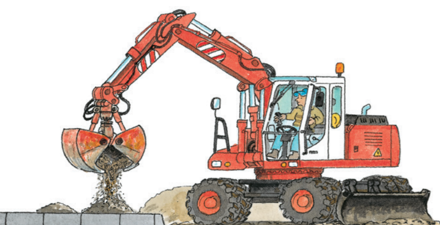
Deze mobiele graafmachine rijdt niet op kettingen, maar op brede wielen. Met de grijper kan de graafmachine aarde en zand oprapen, alsof het twee handen zijn.
