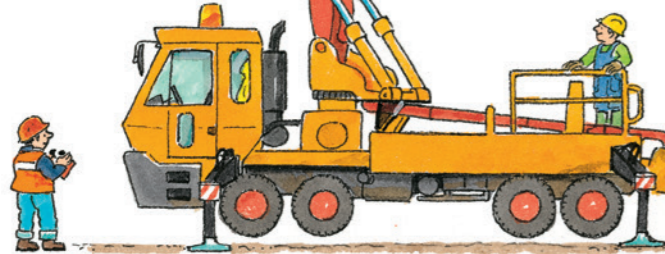
de kraanwagen met betonpomp
