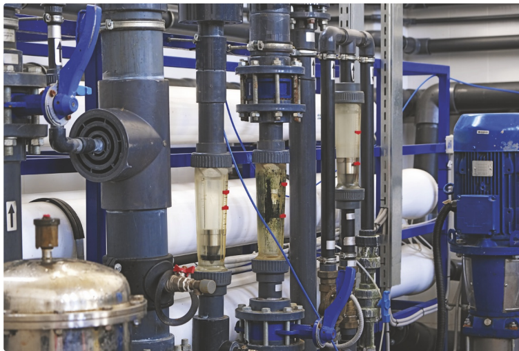
Figuur 10 Het filtersysteem in deze fabriek reinigt het water dat in het productieproces wordt gebruikt en ontdoet het van geuren. (Bron: Shutterstock / Trofimov Denis)
