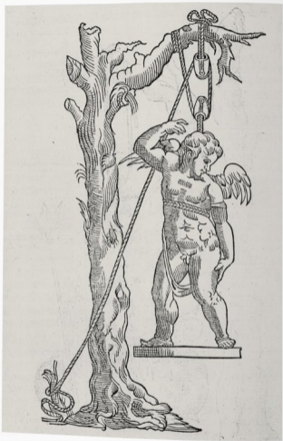
1 | Illustration of how a double purchase pulley works In the first illustrated edition: L'Architettura di Leon Battista Alberti, tradotta in lingua Fiorentina da Cosimo Bartoli Gentil'uomo, Florence, 1650, p. 130/31. Woodcut
